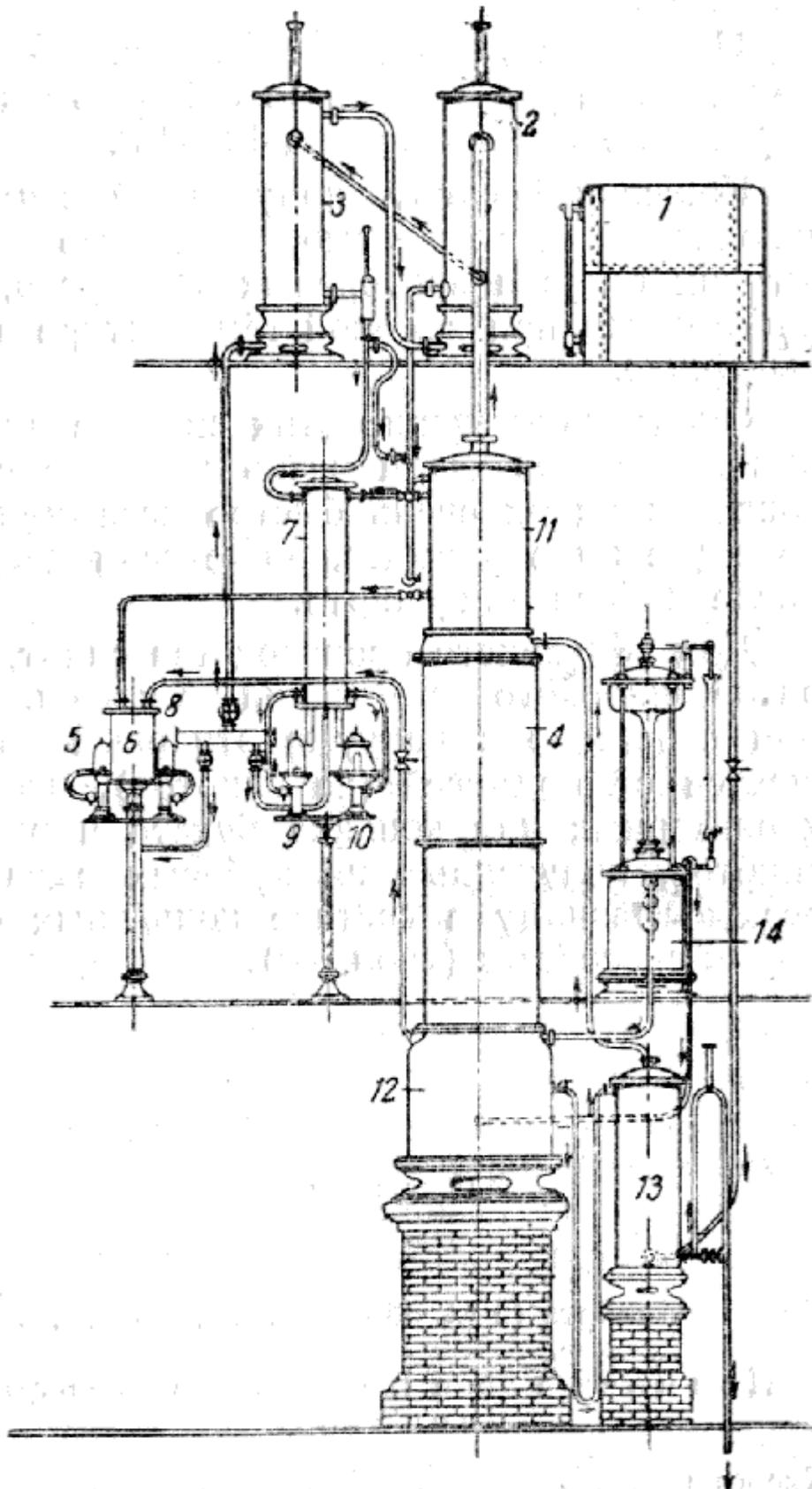
Рис. 8.5. Схема непрерывно действующего промышленного перегонного аппарата
