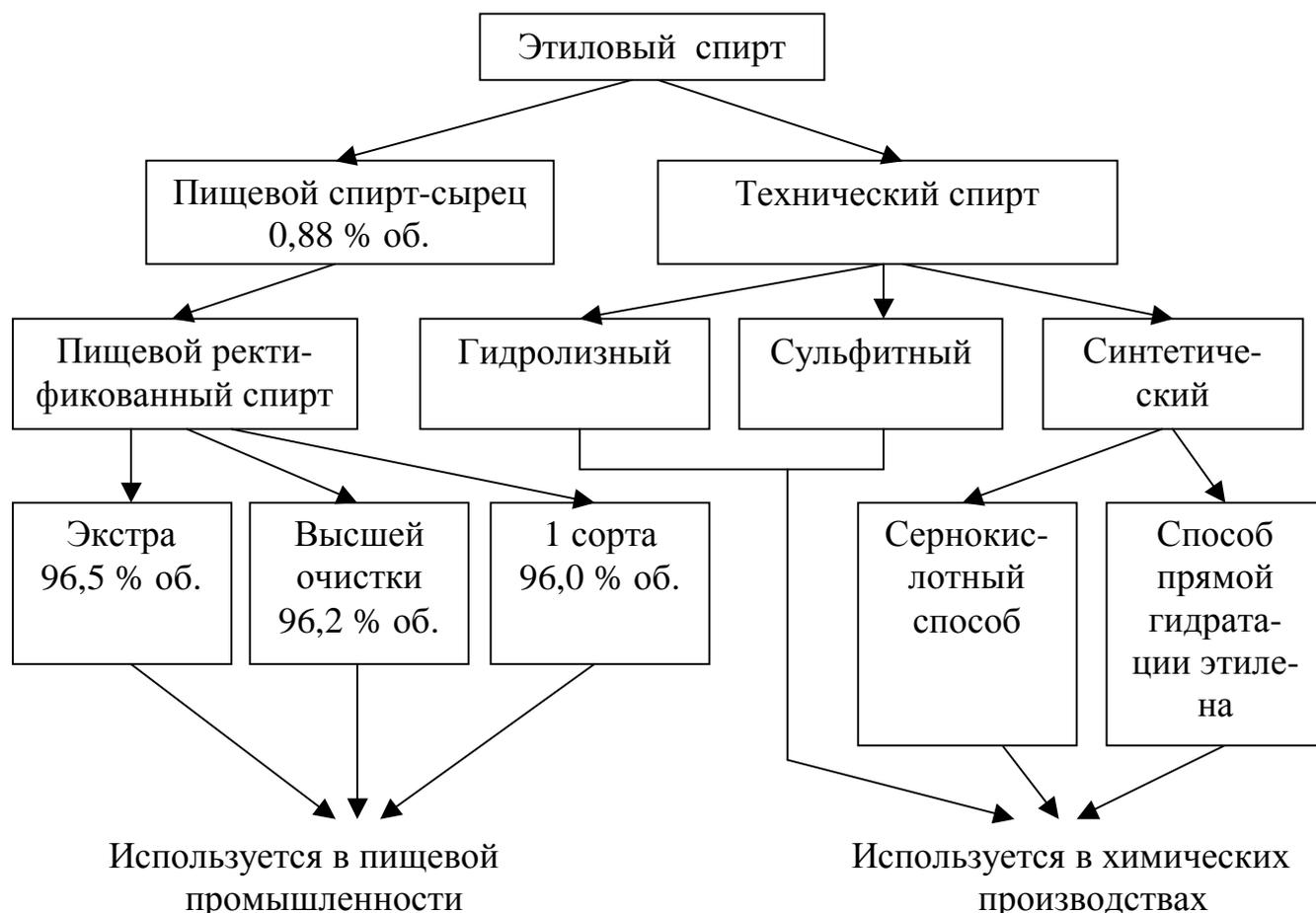
Рис. 1.1. Блок – схема получения этилового спирта
