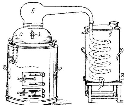
Рис. 8.3. Простой перегонный куб
