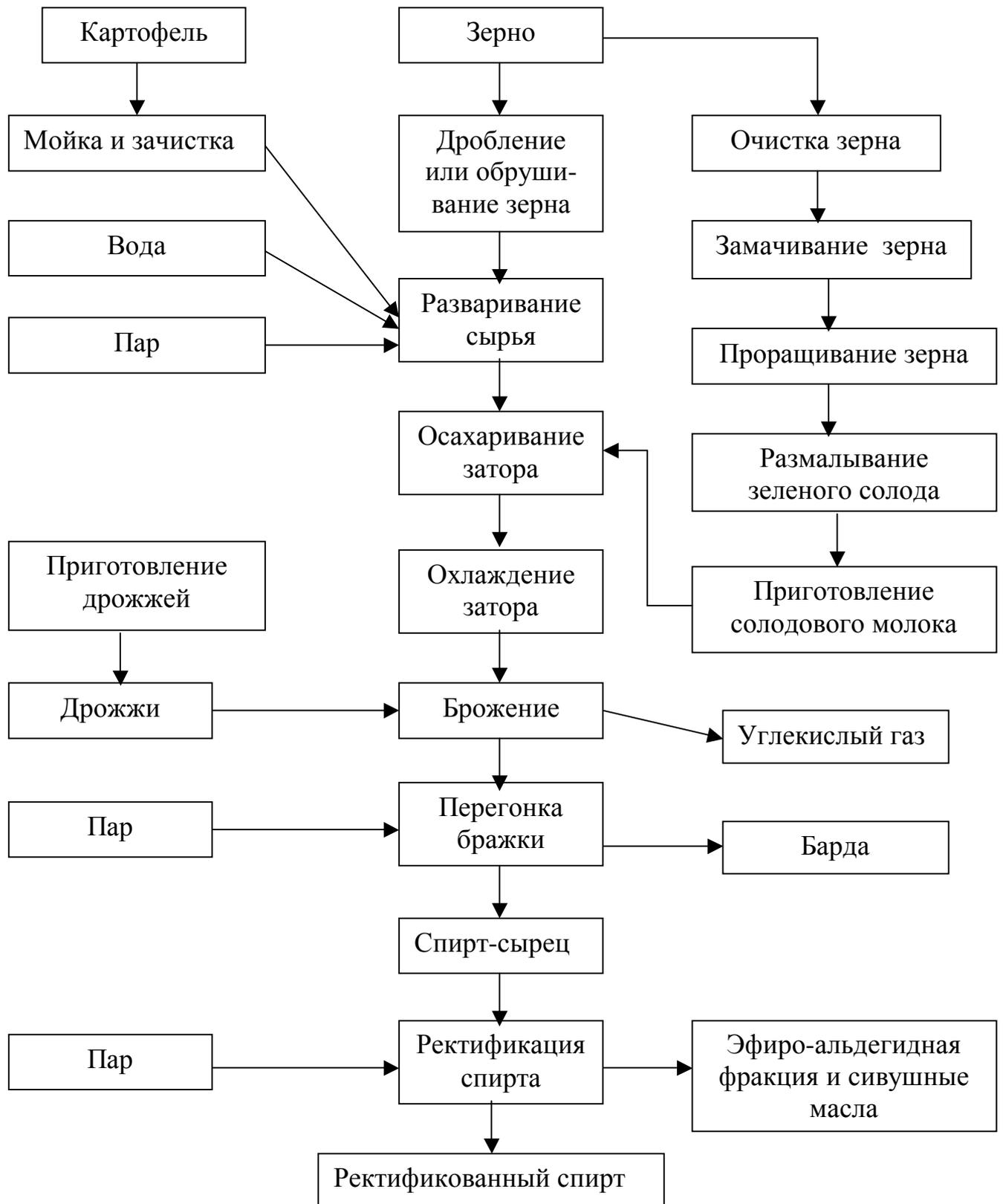
Рис. 6.1. Схема производства спирта-сырца
