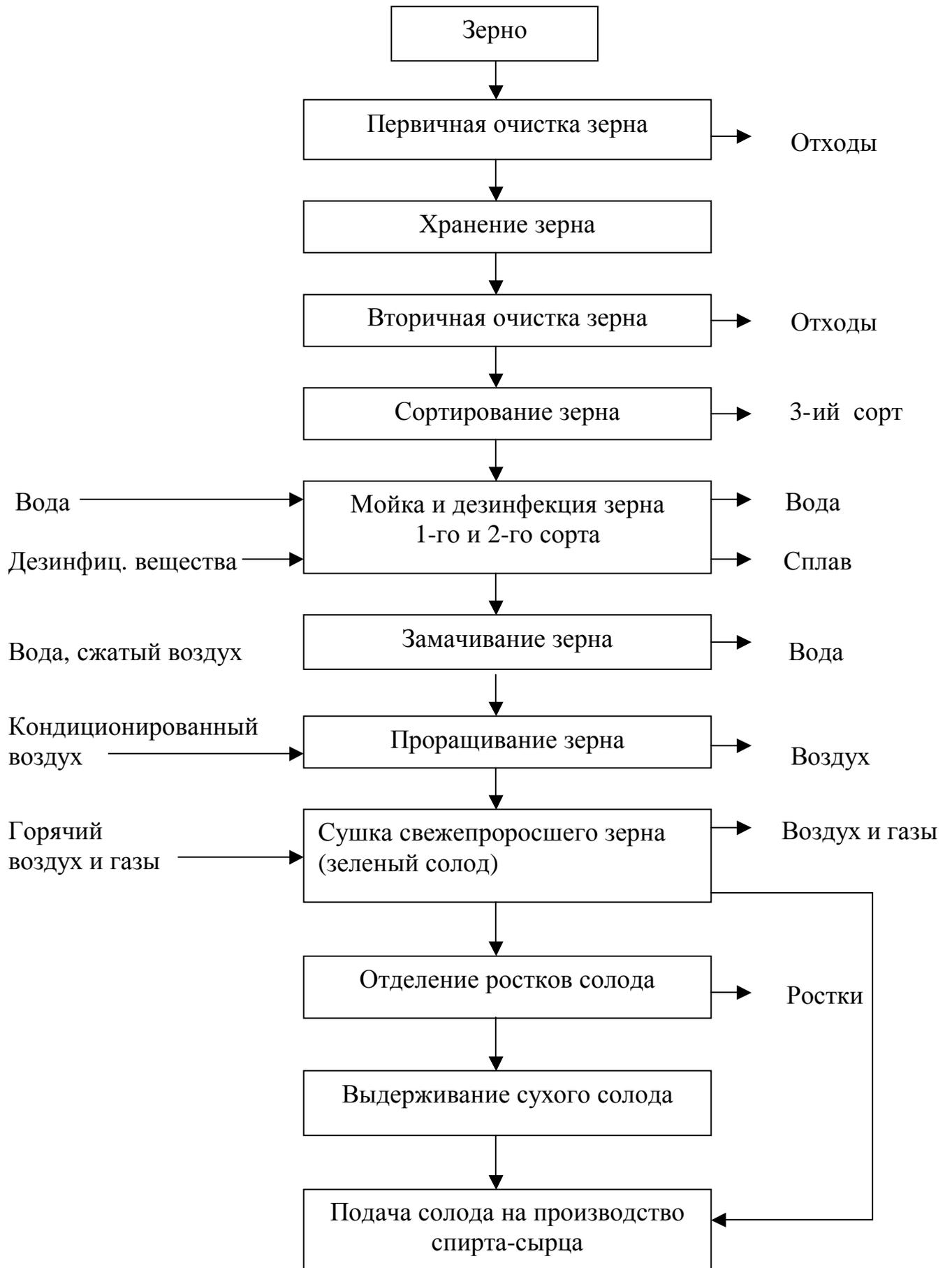
Рис. 4.1. Блок – схема производства солода
