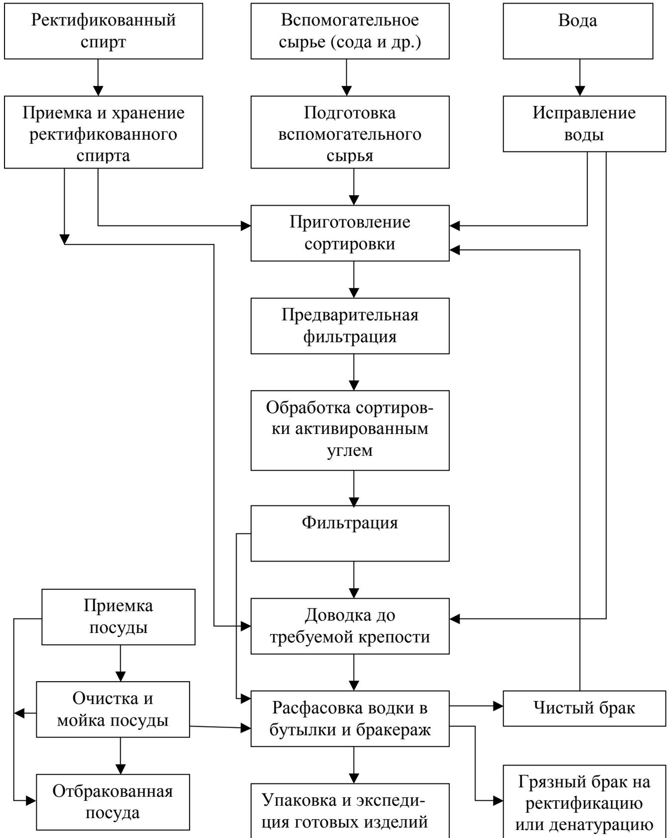
Рис. 10.1. Блок – схема технологического процесса производства водки
