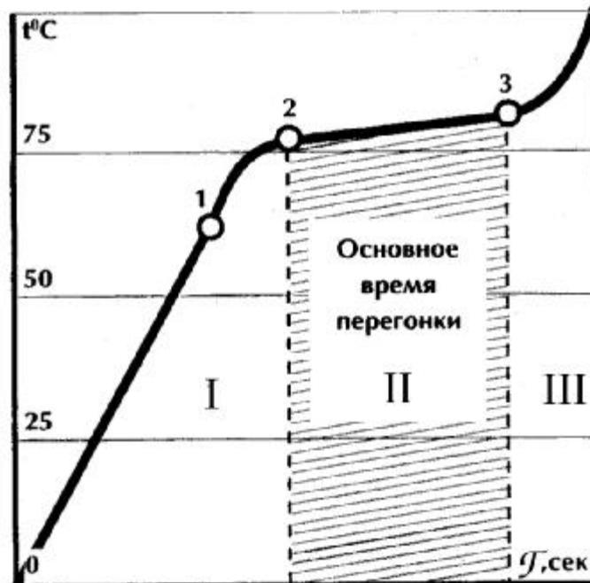
Рис. 8.1. Кривая процесса перегонки спирта-сырца
